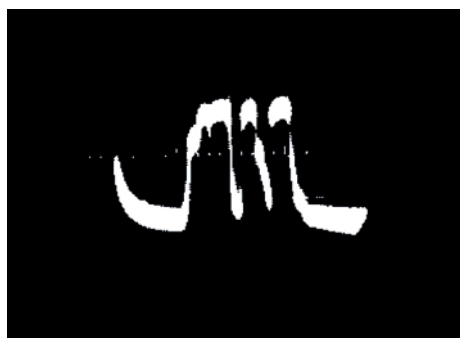
Fig. 4. Gli echi A-mode che Wild e Neal rilevarono da tre tratti sovrapposti di parete di intestino tenue di cane. Gli intervalli tra i picchi sulla linea di base (visibile come linea tratteggiata orizzontale al centro della figura) indicano i relativi spessori [da Ref. 26, © 1950 Elsevier. Reproduced under STM Permissions Guidelines with proper acknowledgment].
