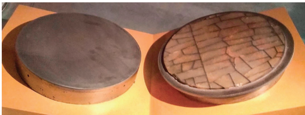
Fig. 3. Trasduttore risonante a sandwich di quarzo progettato da Langevin, aperto per mostrare il mosaico di lamine di quarzo interposto tra due piastre di acciaio. Esemplare appartenuto alla Marina francese, ora esposto all'ESPCI di Parigi. [Fonte: Physics Today, 75, 2022. © 2022 AIP Publishing. Riprodotta con autorizzazione per uso non commerciale]. https://doi.org/10.1063/PT.3.5122 .
